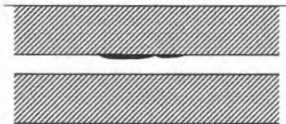
شکل ب: تصویر در کلیشه پرتونگاری پاس ریشه LOF
